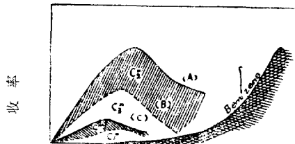
轉換率 그림 5. 轉換率과 生成不飽和炭化水素 및 Benzene 收率과의 關係
